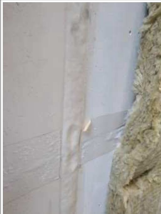
Belvorming na S 200 -test naad 3
