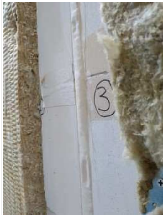
Belvorming na S 200 -test naad 3
